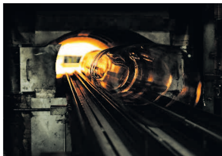
Zaubert Scheiben aus dem Zylinder: Der Glasmacher bläst Luft durch die hohle Stange, die Pfeife heißt. Er dreht dabei die glühende Masse wie Honig. Der entstehende Zylinder wird der Länge nach aufgeschnitten und legt sich unter geringerer Hitze flach. Im Ofen herrschen bis zu 1500 Grad. Fotos Hersteller
